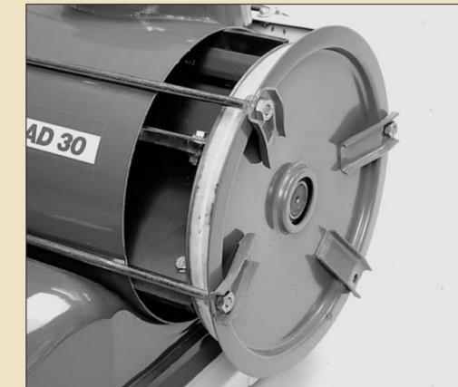
Au lieu de tôles d'acier, le rotor de l'écluse est pourvu de pales en caoutchouc résistant aux petits cailloux et clous etc. sans être endommagées.
