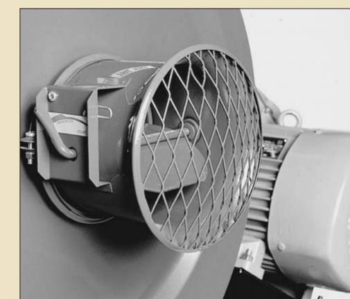
Les ventilateurs à haute pression (sauf TRL 20/40/75) sont munis d'un régulateur d'air automatique ménageant les grains, puisque la vitesse de l'air est toujours limitée à 25 m/s sans aucune perte de capacité.
